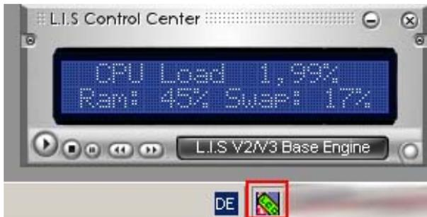
Nach Start des Programms kann man auswählen was später alles auf dem LCD-Display gezeigt werden soll. In das Menüauswahl kommt man per „Rechtsklick“ auf das ‚LIS Control Center‘:
